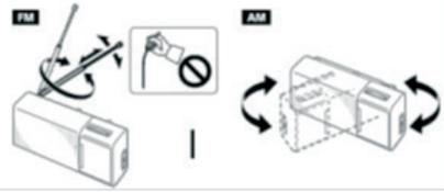
Прибор оснащен внешней телескопической антенной. Для обеспечения наилучших условий приема в диапазоне FM отрегулируйте наклон и длину антенны.
