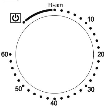
Поворачивая ручку по часовой стрелке установите нужное время приготовления. Вы также можете просто включить работу печи без использования таймера, для этого поверните ручку таймера в положение
