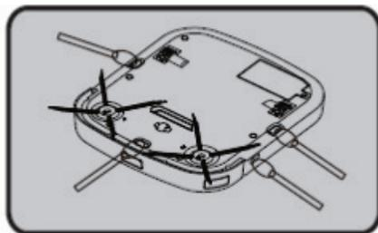
После каждого использования протирайте датчики сухой мягкой тканью.
