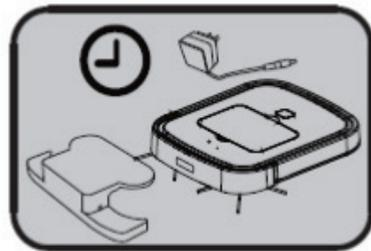
Перед первым использованием прибора либо после длительного перерыва заряжайте батарею в течение 8 часов. При этом первые 3-4 раза ис-
