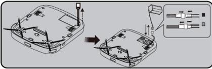
1. С помощью отвертки открутите винт в крышке батарейного отсека и снимите крышку.
