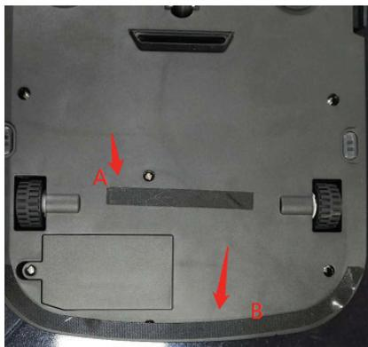
1. Перед первым использованием пылесоса для влажной уборки закрепите на нижней стороне пылесоса ленту-липучку, входящую в комплект поставки. Для крепления ленты снимите с ее клеевой стороны защитную пленку и приклейте ленту к основанию пылесоса. Места крепления ленты обозначены на рисунке стрелками А и В.
