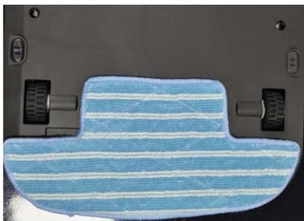
2. Смочите водой тряпку для влажной уборки и плотно прижмите ее к ленте-липучке, закрепленной на днище пылесоса.
