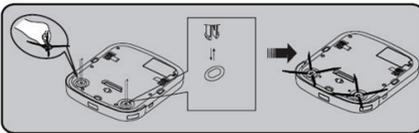
Чтобы установить щетку, возьмите ее по центру с двух сторон и прижмите на посадочное место до фиксации. Убедитесь, что щетка надежно закрепилась. Перед каждым запуском пылесоса проверяйте, что щетки закреплены на приборе.
